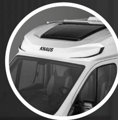
La tecnologia all'avanguardia LFI (Long Fibre Injection) viene utilizzata sul cupolino del tetto del VAN TT con isolamento integrato. Grazie al poliuretano fibrorinforzato qui utilizzato, i componenti sono particolarmente leggeri e allo stesso tempo robusti e resistenti, anche in condizioni estreme di calore e freddo
