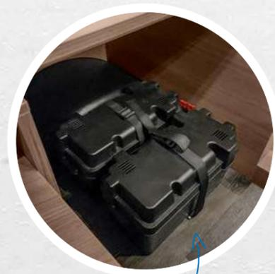
*Organizzato al meglio! Grazie al posizionamento centrale dell'impianto elettrico del veicolo nel garage posteriore, come qui nel VAN TI, tutti gli elementi importanti sono facilmente accessibili e ben in vista. Ciò consente di risparmiare tempo in caso di manutenzione*
