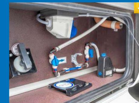
4. Il componente flessibile garantisce la fornitura d'acqua quando non avete un filtro di ricambio.
